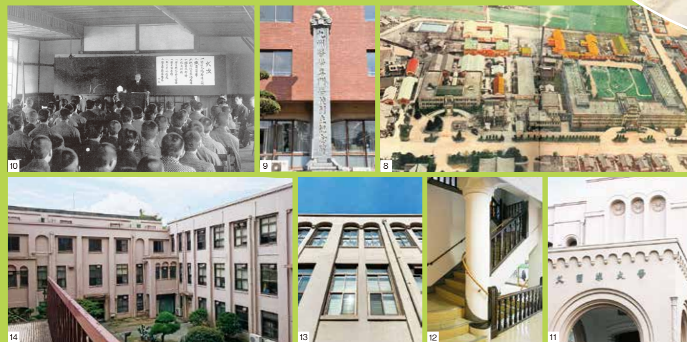
1 階段教室での授業風景 2 設立当時の教務室。現在は総務課 3 本館玄関の腰壁タイルの中にある「九州医学専門学校」銅製銘板 4 建築中の大学本館 5 文化財登録のプレート 6 1階部分は半地下のような構造 7 階段教室のある2階につながる車寄せ 8 昭和30年ごろの航空写真 9 本館南側の西面に建つ記念塔。4つの球は学生・教職員・久留米市民・福岡県医師会を具現化 10 仮校舎で行われた第1回入学式 11 親しみを感じさせるためアーチを多用した表現 12 階段部分の柱はアバスクとエキヌスで構成された独特な造形 13 両翼は2連のアーチを並べた窓 14 コの字型の中庭
